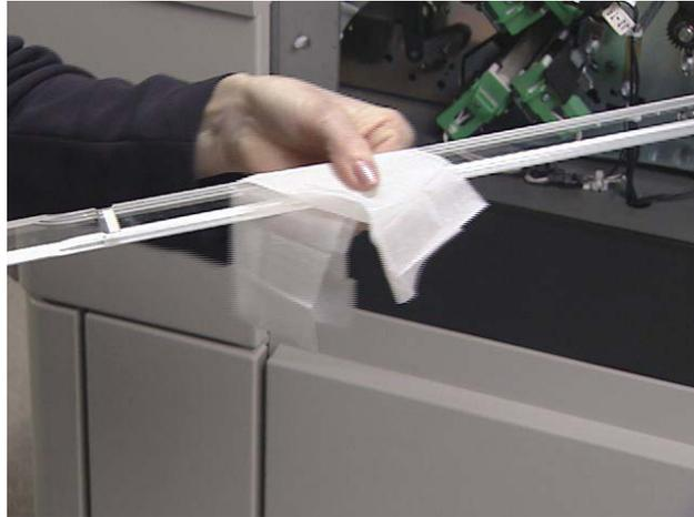
3. Reinstale a guia para imagem superior. Verifique se o lado chanfrado está voltado para cima e se a guia para imagem está totalmente para dentro e totalmente encaixada em sua abertura.
