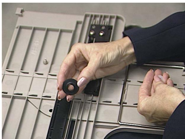
5. Coloque o espaçador engrenado no local adequado, certificando-se de alinhar os dentes nas barras.
