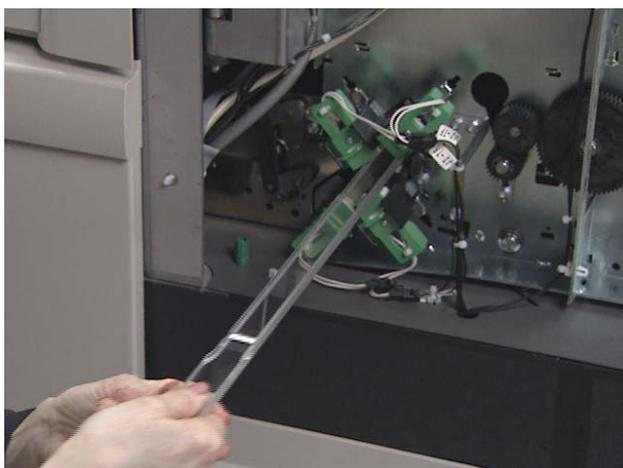
4. Coloque a guia para imagem inferior em uma superfície limpa.
