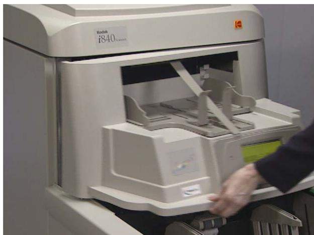
2. Levante a tampa do rolo e limpe os sensores.
