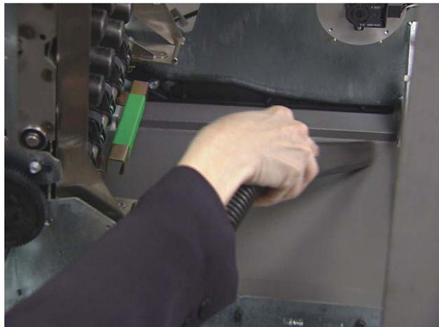
7. Levante a placa de transporte vertical para a posição original.
