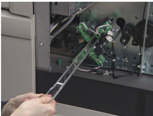
3. Coloque uma nova guia para imagem superior no local apropriado. Verifique se o lado chanfrado está voltado para cima e se a guia para imagem está totalmente para dentro e totalmente encaixada em sua abertura.
