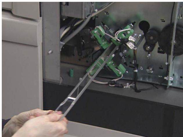
6. Coloque a guia para imagem superior em uma superfície limpa.
