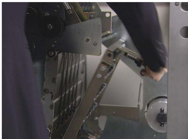
2. Deslize para fora a placa difusora horizontal e limpe o interior do encaixe.
