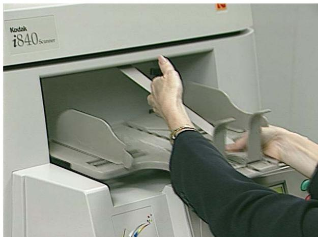
2. Abra as guias laterais expandindo o máximo possível, remova a barra de bloqueio e vire a bandeja de cabeça para baixo.
