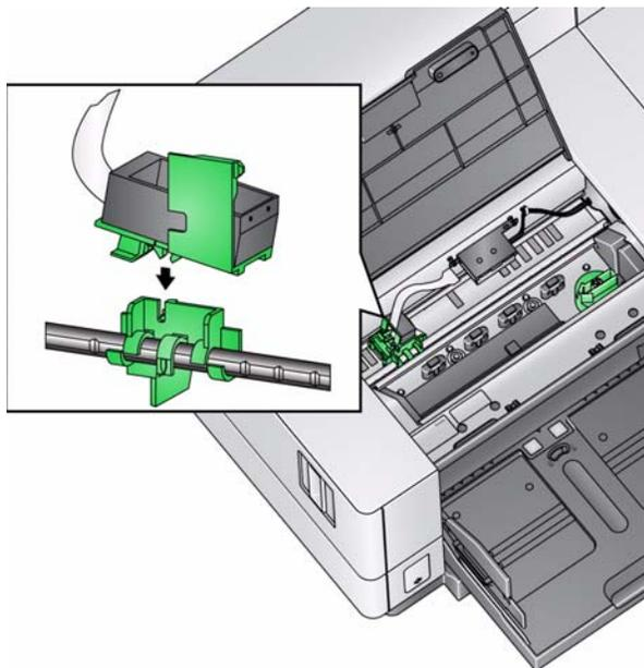
17. Conecte o cabo da impressora do suporte da impressora ao lado esquerdo da placa de circuito da impressora. Verifique se o lado de cobre do cabo da impressora está voltado para baixo.
