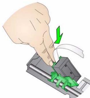
21. Encaixe o cartucho de tinta no suporte da impressora conforme mostrado.
