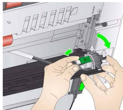
6. Instale o fundo rotatório conectando o cabo e alinhando as molas na extremidade do fundo rotatório. Aperte os parafusos borboletas em suas posições. *Cuidado para não apertar demais.*
